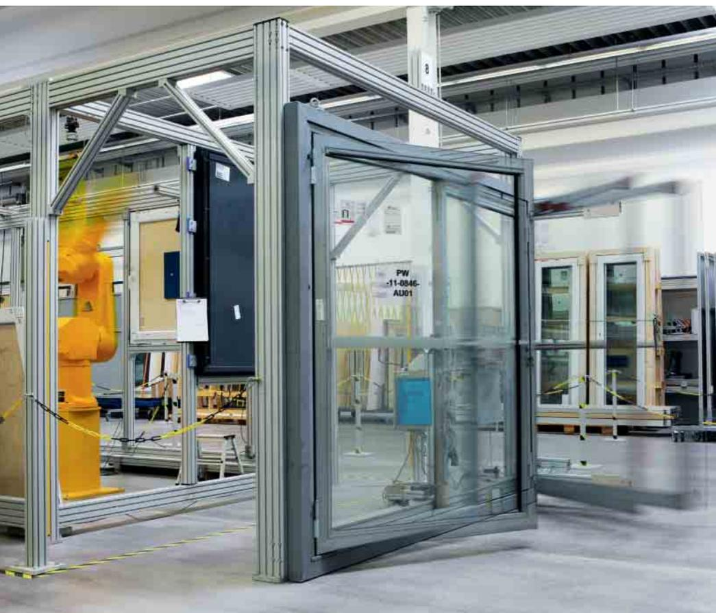
Im Dauertest erreichen Fenster 20.000 und Türen bis zu eine Millionen Öffnungs- und Schließ-Zyklen. So lassen sich auch Einsätze unter Extrembedingungen simulieren.
