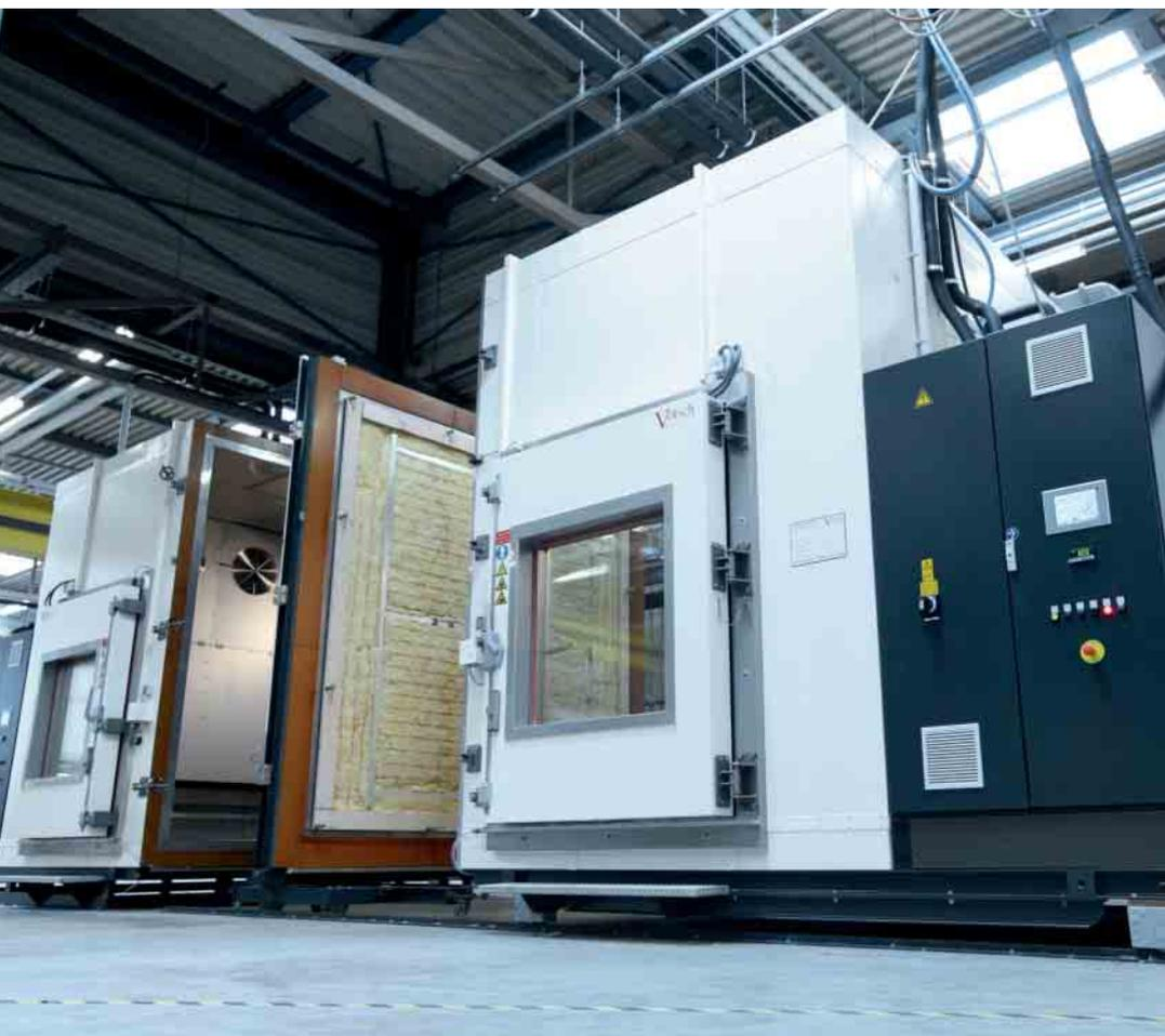
Die Differenzklimakammer ermöglicht Temperaturprüfungen von -60 bis +90 Grad Celsius. Das umfasst alle klimatischen Verhältnisse auf der Erde. In weiteren Prüfeinrichtungen werden Temperatur- und Feuchtigkeitszyklen simuliert, Wärmedurchgangskoeffizienten ermittelt sowie Korrosionsbeständigkeit oder Witterungseinflüsse geprüft.
