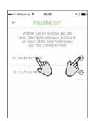
**Hinweis:** Sie können die Module in der Liste identifizieren, indem Sie auf das Fadenkreuz tippen. Die LED auf der Unterseite des Moduls blinkt.
