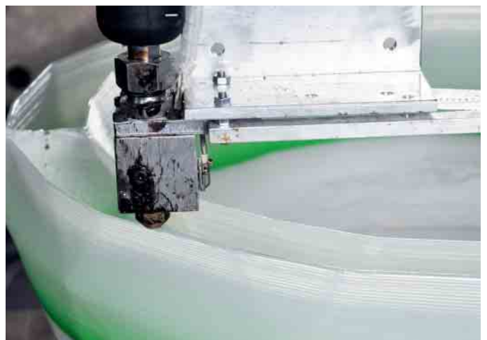
▲ 3-D-Fertigung eines Fensters für das Grachtenhaus von DUS architects ◀ das von Softkill Design entwickelte 3-D-Druck-Projekt »Protohouse«
