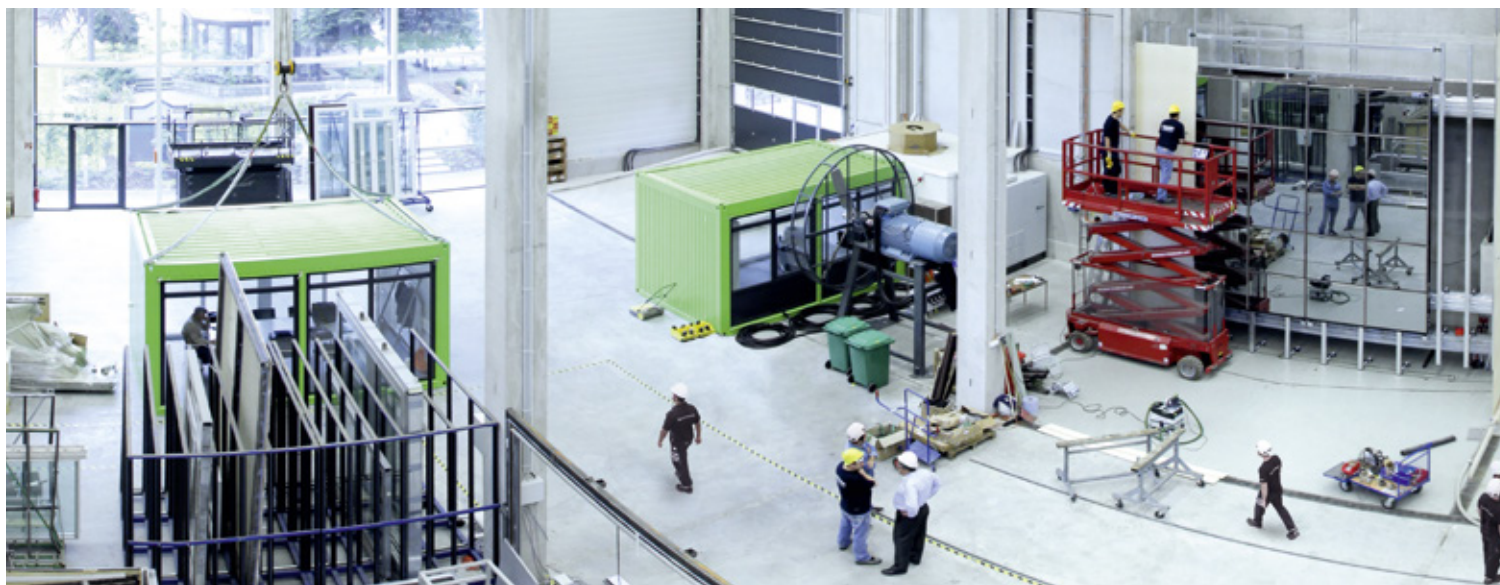
Schüco façade test rig Bancada para testes de fachada da Schüco
