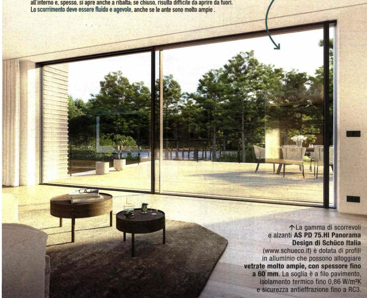
↑ La gamma di scorrevoli e alzanti **AS PD 75.HI Panorama Design di Schüco Italia** ([www.schueco.it](http://www.schueco.it)) è dotata di profili in alluminio che possono alloggiare **vetrate molto ampie, con spessore fino a 60 mm**. La soglia è a filo pavimento, isolamento termico fino 0,86 W/m<sup>2</sup>K e sicurezza antieffrazione fino a RC3.
