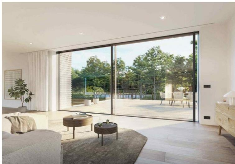
Grazie alla robustezza dell'alluminio, il sistema può supportare superfici vetrate ampie fino a 3.500 mm di altezza e 800 Kg di peso (nella versione scorrevole motorizzata TipTronic), mantenendo profili in vista snelli.
