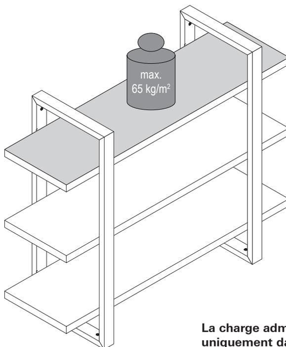
**La charge admissible maximale s'applique uniquement dans les limites du système indiquées !**
