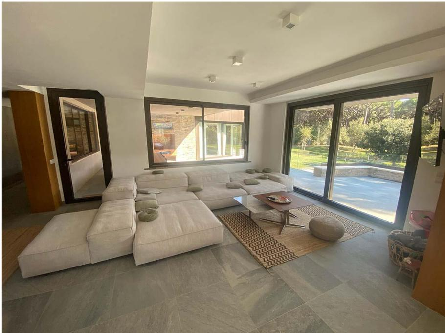
Nella zona living e nelle stanze, i sistemi scorrevoli Schüco **ASS 41** massimizzano l'apporto di luce naturale negli ambienti, attraverso il nodo centrale snello e i profili sottili che permettono la realizzazione di ampie trasparenze.
