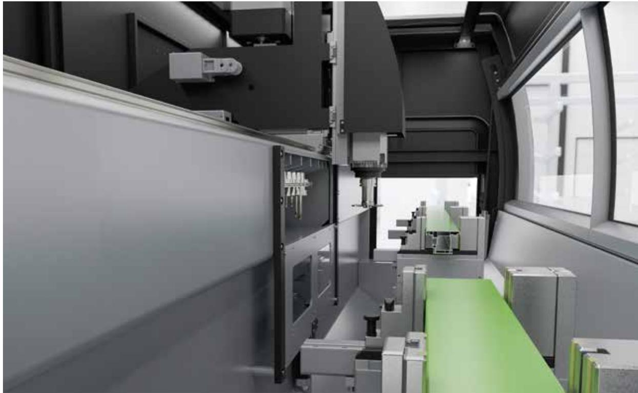
Die 30° Einlegeposition ermöglicht ein ergonomisches Einlegen der Profile und gibt eine bessere Einsicht auf die Spannsituation.
