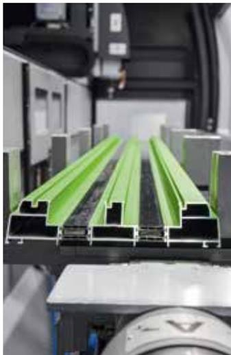
2-stufiger Spannbereich ermöglicht das Spannen eines 3-gleisigen Schiebeelementes der Serie ASS 70.HI
