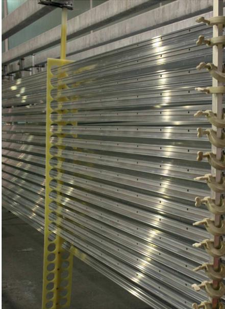
*Sicherung der Bauteile durch Einlegen in Kunststofflochgestelle*
