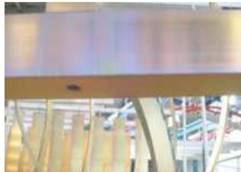
*Bohrungen zur Belüftung und zur Entlüftung für Hohlkörper und für Rahmenkonstruktionen*
