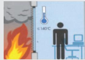
**Classe EI** - Etanchéité aux flammes, aux fumées et aux gaz et isolation thermique pendant l'incendie. La température mesurée sur la menuiserie coté opposé au feu est limitée à 140° en moyenne et 180° en tout point. L'air ambiant sera d'environ 37°.
