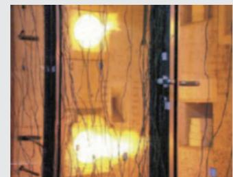
Schüco a réalisé les essais normalisés suivant la courbe de montée en température : 600° coté feu au bout de 10 mn, 821° après 30 minutes et 925° au bout d'une heure.
