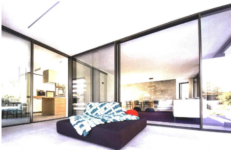
Utilizzabile sia tra esterno e interno che negli interni, il programma è caratterizzato da modularità, profili snelli, esclusivi sistemi di chiusura, minimi ingombri e soprattutto dalla soglia 0 Level, a filo pavimento, che garantisce facilità di accesso ad anziani, bambini e persone che si muovono su ausili (foto Matilde Franzolin, Studio Maat)
