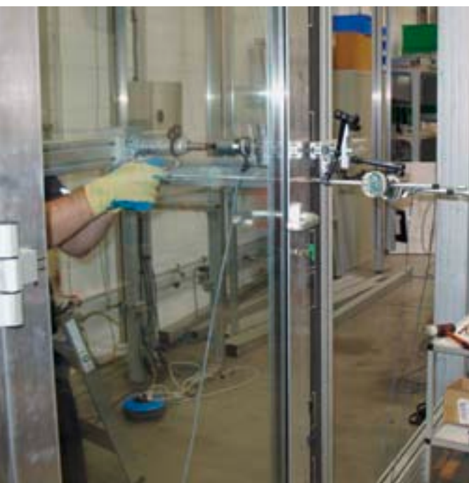
Sind für Bauteile bestimmte Widerstandsklassen gefordert, führen Schüco Mitarbeiter Tests nach Norm durch.
