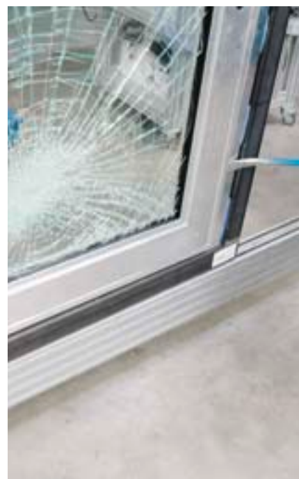
Der Test ist bestanden, besteht die Tür den fünfminütigen Einbruchversuch.
