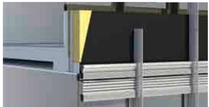
Die Modernisierungsfassade Schüco ERC 50 wird zum größten Teil von außen montiert, sodass der Betrieb im Inneren fast ungestört weiterlaufen kann.
