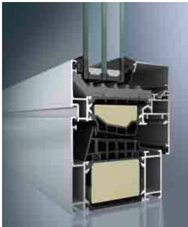
Vereint die Vorteile des Werkstoffes Aluminium mit hoher Wärmedämmung: Schüco Fenster AWS 90.SI + . Es erreicht Passivhausstandard – etwa durch Schaumverbundisolerstege, die in der Dämmzone liegen.
