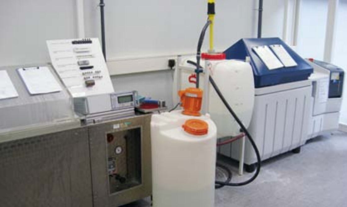
Korrosionsprüfung in Salzsprühprüfkammern (links); Künstliche Bewitterung in Xenonbogenprüfgeräten (rechts)
