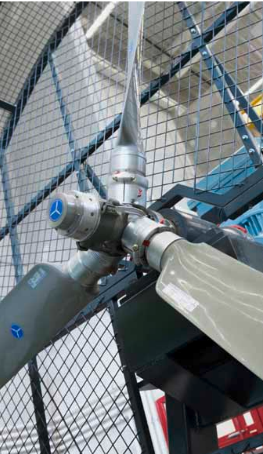
Die Windmaschine mit 450 Kilowatt Leistung und einem Propeller mit 2,76 m Durchmesser kann einen Orkan simulieren.
