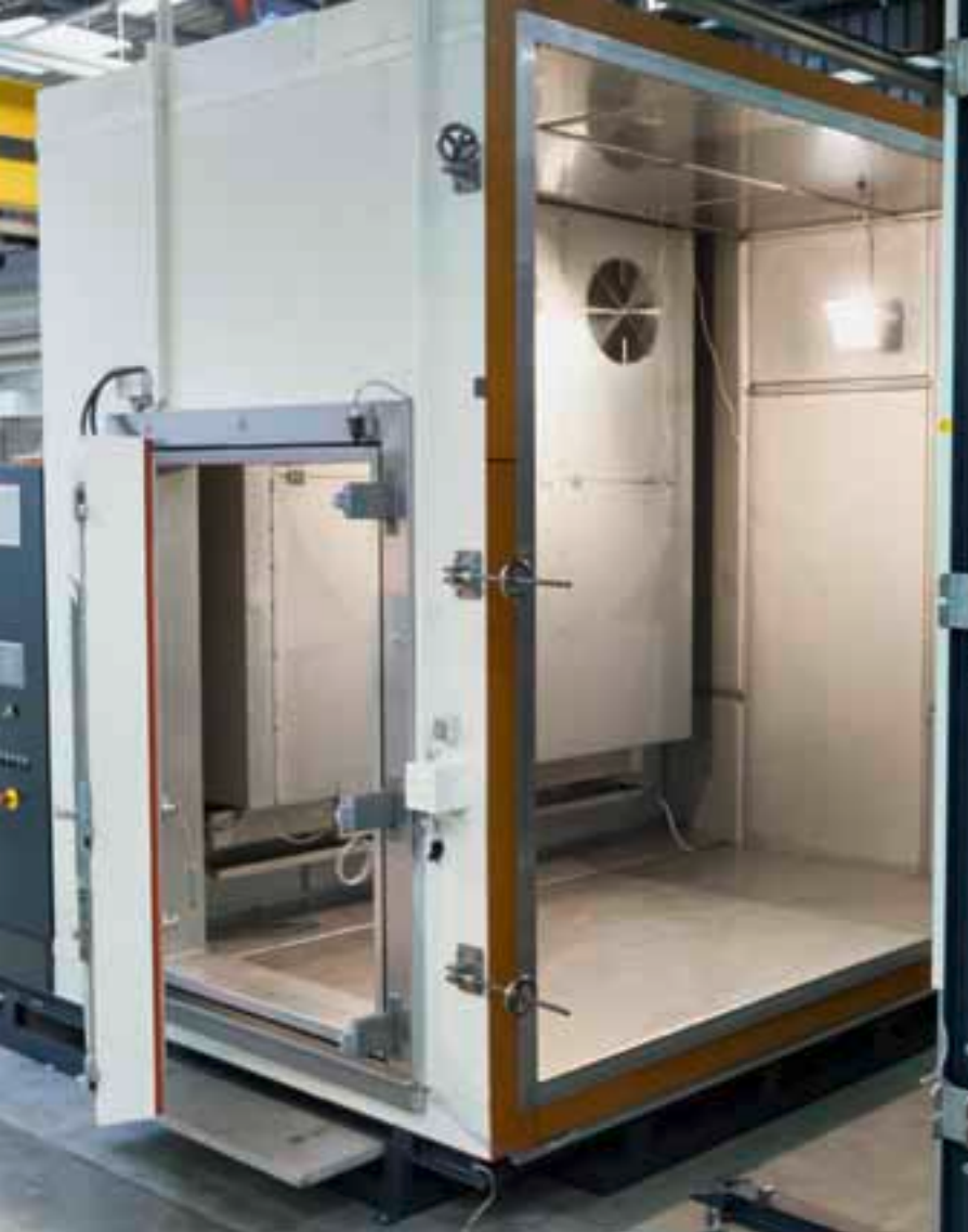
Wie wirkt sich das Klima aus? Antworten gibt u. a. die Differenzklimakammer. Sie simuliert Temperatur- und Feuchteunterschiede.
