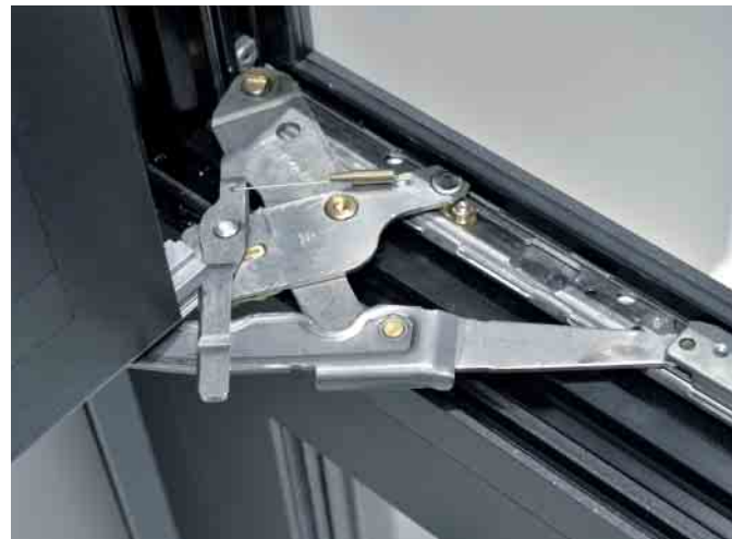
Neue Drehklappschere: Die neue Beschlagsgeneration für Schüco AWS 75.SI+ OpenOut erlaubt ein Flügelgewicht bis 130 kg bei einem 90°-Öffnungswinkel.
