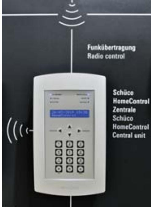
Praktisch: Die funkgesteuerte Alarm- und Meldetechnik Schüco HomeControl zeigt zum Beispiel, wo durch ein offenes Fenster Wärme entweicht.
