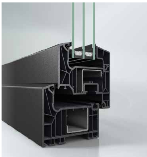
Schüco LivIng 82 AS erreicht bei schmalen Ansichtsbreiten und Anschlagdichtung einen U_f -Wert von 1,0 \text{ W}/(\text{m}^2\text{K}) .
