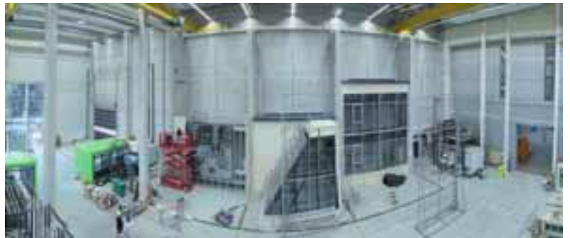
Die Panorama-Aufnahme zeigt die 18 m hohe Halle, in der die Dichtheitsprüfungen stattfinden.
