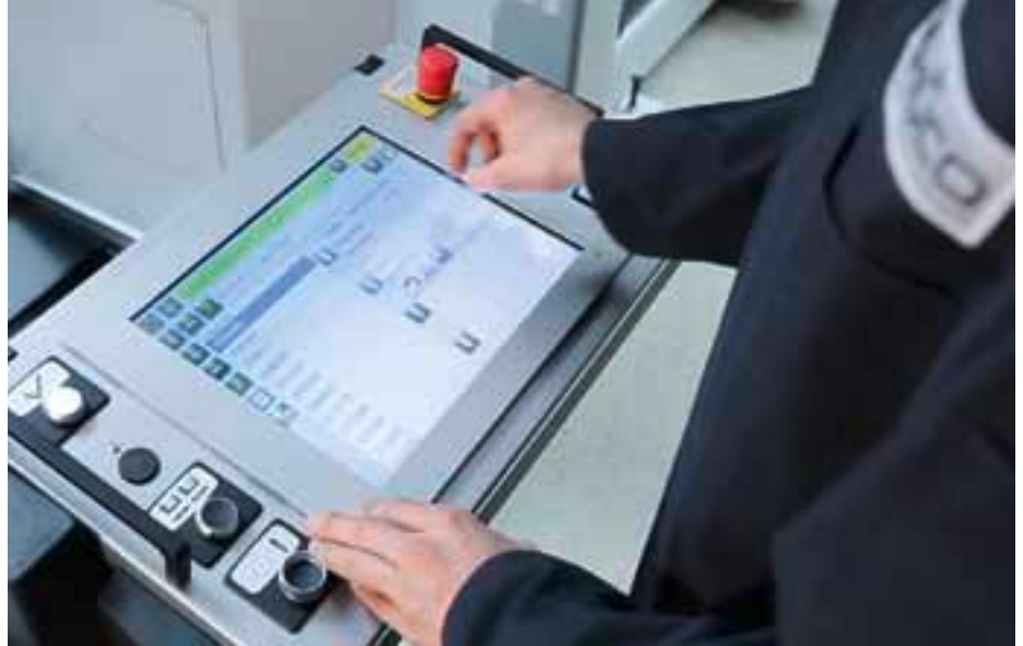
Ergonomisches, verfahrbares Bedienpult mit großem Touch-Screen zur schnellen Bedienung
