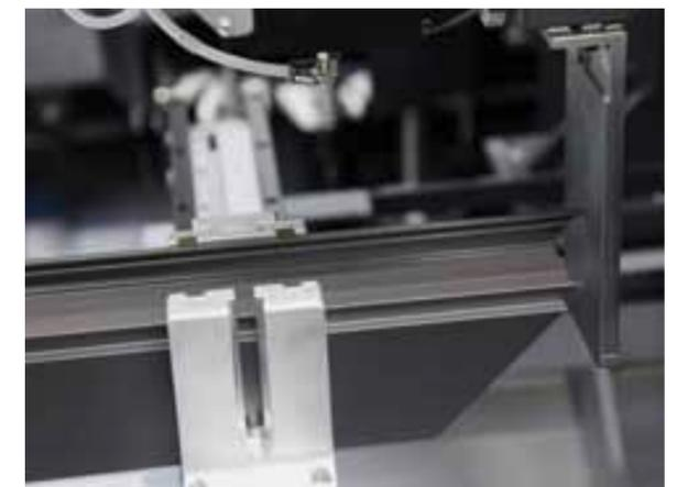
Präzise Messtechnik ermöglicht automatische Längenmessung zur Korrektur der Längentoleranzen (optional).
