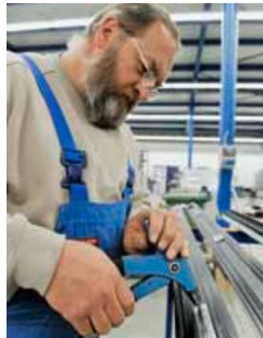
Ein Monteur befestigt die Prüfnummer im Türfalz: Sie steht für Qualität und Sicherheit.
