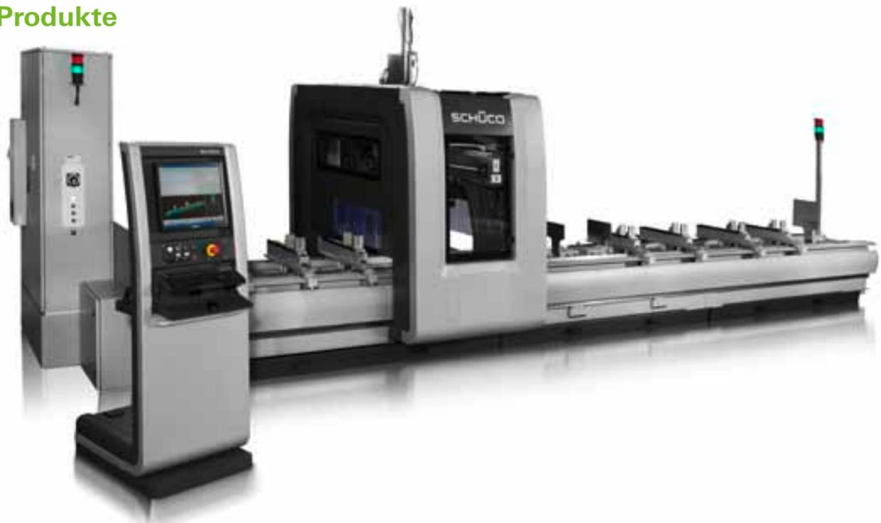
Neu und überzeugend: die Schüco MFM AF 450. Mit einer Bearbeitungslänge von 7.200 mm ist sie auch bei der Fertigung großer Elemente schnell und präzise.
