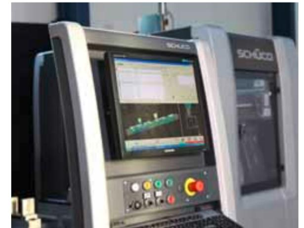
Ergonomisch: Einfachste Bedienbarkeit mit beweglichem Terminal und menügeführter Software Schüco CAM auf einem 19-Zoll Monitor.
