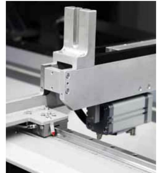
Automatische Spannerpositionierung (ASP) durch einzeln angetriebene Spannbocke ermöglichen flexible schnelle Bearbeitungen.
