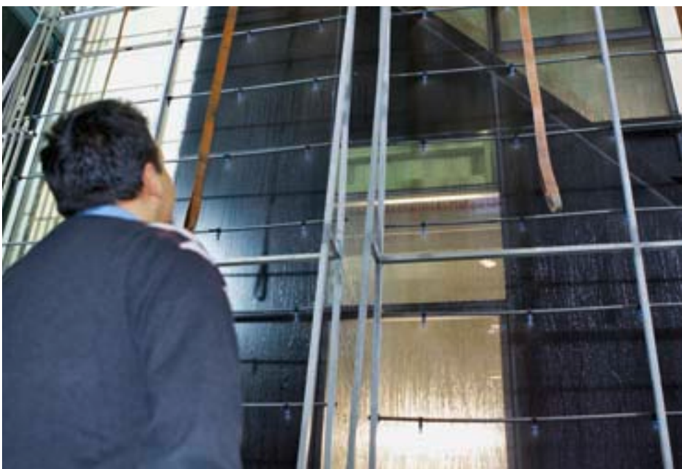
Das Technologiezentrum Bielefeld bietet optimale Möglichkeiten, Fassadenelemente unter realistischen Bedingungen ausgiebig zu testen.
