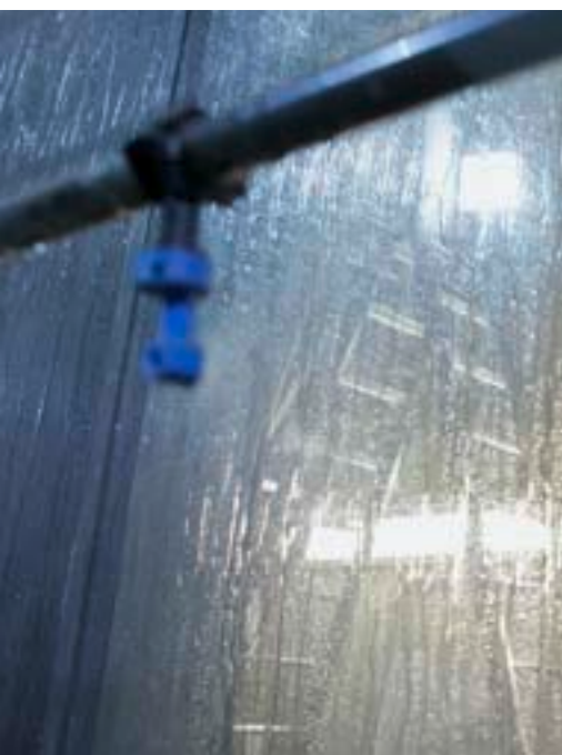
Bei der Regenprüfung wurde ein Druck von 1.200 Pascal angesetzt.
