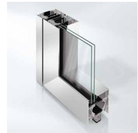
Das Brandschutzsystem Schüco FireStop ADS 90 FR 30: falzoffene 3-Kammer-Profilgeometrie mit einer Bautiefe von 90 mm.
