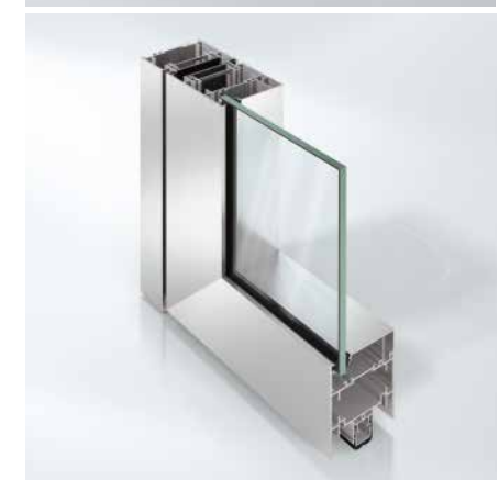
Das Rauchschutzsystem Schüco FireStop ADS 76.NI SP: falzoffene 1-Kammer-Profilgeometrie mit einer Bautiefe von 76 mm.
