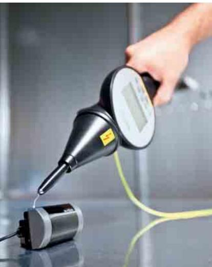
Um die Vorgaben der EMV-Richtlinie einzuhalten sind diverse Prüfungen zu leistungsgeführten Störungen durch deren exakte Nachbildung in einer neuen Schirmkabine möglich. Die Prüfungen dienen der Optimierung von Schüco Produkten oder Fremdteilen, um bauseitige EMV-Anforderungen zu erfüllen.
