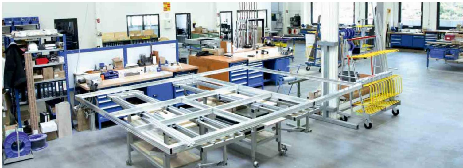
In der Schüco Versuchswerkstatt werden alle Arten von Baumustern und Prüfelementen wie in einem eigenen Metallbaubetrieb hergestellt. Dafür stehen auf einer Fläche von gut 2.000 m<sup>2</sup> unter anderem ein CNC gesteuertes Profilbearbeitungszentrum und eine Doppelgehrungssäge sowie sonstige gebräuchliche und aktuelle Metallbearbeitungsmaschinen.
