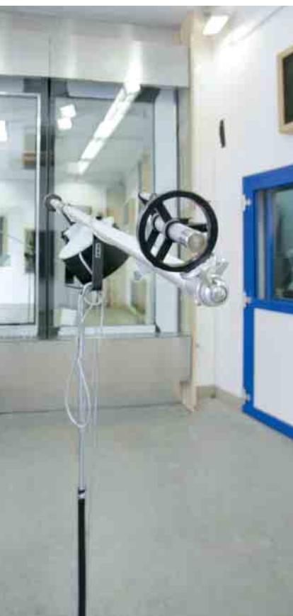
Hier werden Systemprüfungen für Fenster- und Raumtrennsysteme sowie für komplette Fassadenelemente im Format 2,8 x 3 m (Transmission) und 6 x 6 m (Flankendämmung) durchgeführt. Gemessen wird die Luftschalldämmung gegen Außenlärm sowie die Flankendämmung für die Schallübertragung in Innenräumen oder zwischen Geschossebenen.
