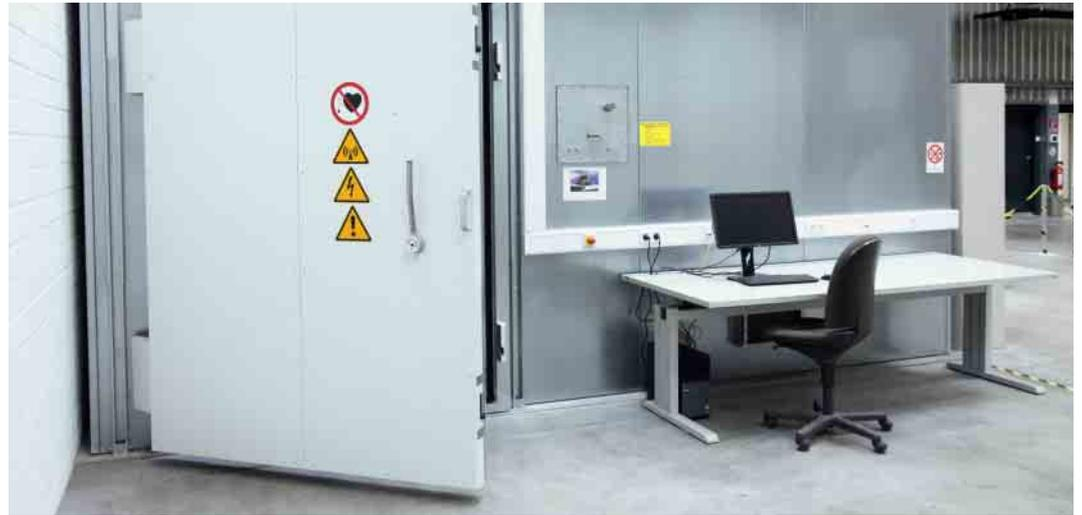
Um die Vorgaben der EMV-Richtlinie einzuhalten sind diverse Prüfungen zu leitungsgeführten Störungen durch deren exakte Nachbildung in einer neuen Schirmkabinen möglich. Die Prüfungen dienen der Optimierung von Schüco Produkten oder Fremdartikeln, um bauseitige EMV-Anforderungen zu erfüllen.
