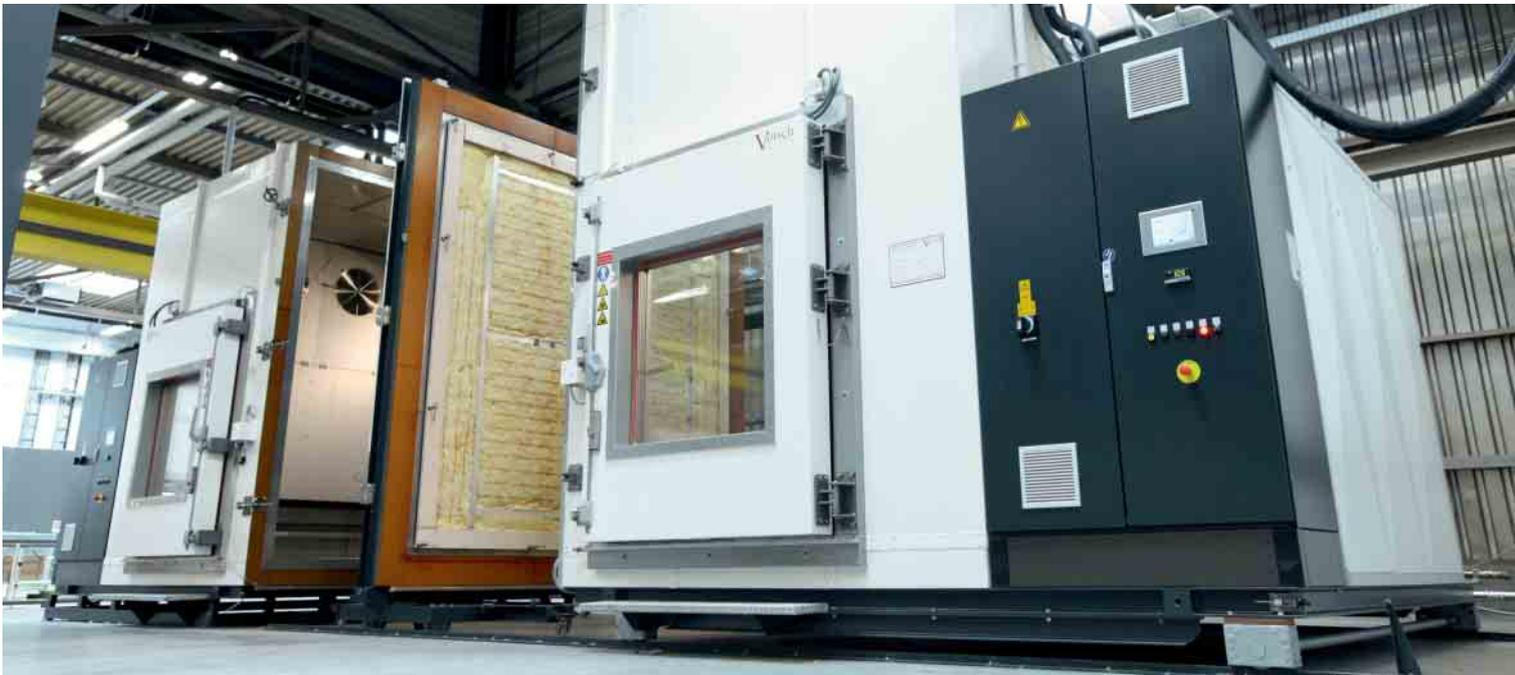
Die Differenzklimakammer ermöglicht Klimaprüfungen im Bereich von -60 bis +90 Grad Celsius und bei unterschiedlichen Feuchtebedingungen.
