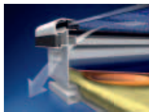
Le aperture di sfogo poste al di sopra dell'assorbitore consentono la veloce eliminazione dello strato di condensa dal collettore.
